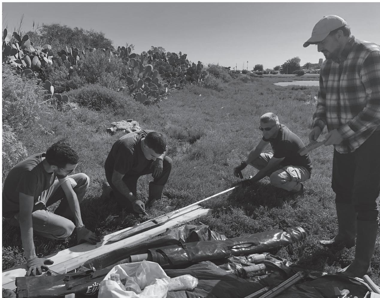
Fig. 2. Fasi operative del rilievo: apertura e prima lettura sul campo del campione raccolto.
